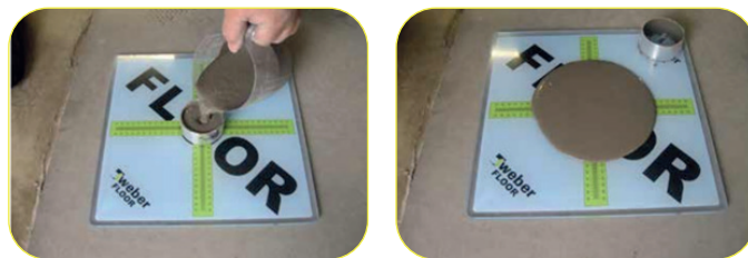
Диаметр пятна распыла для кольцевого теста для наливных полов
